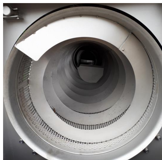
vue interne du tambour dans lequel les matières de vidange se déversent
